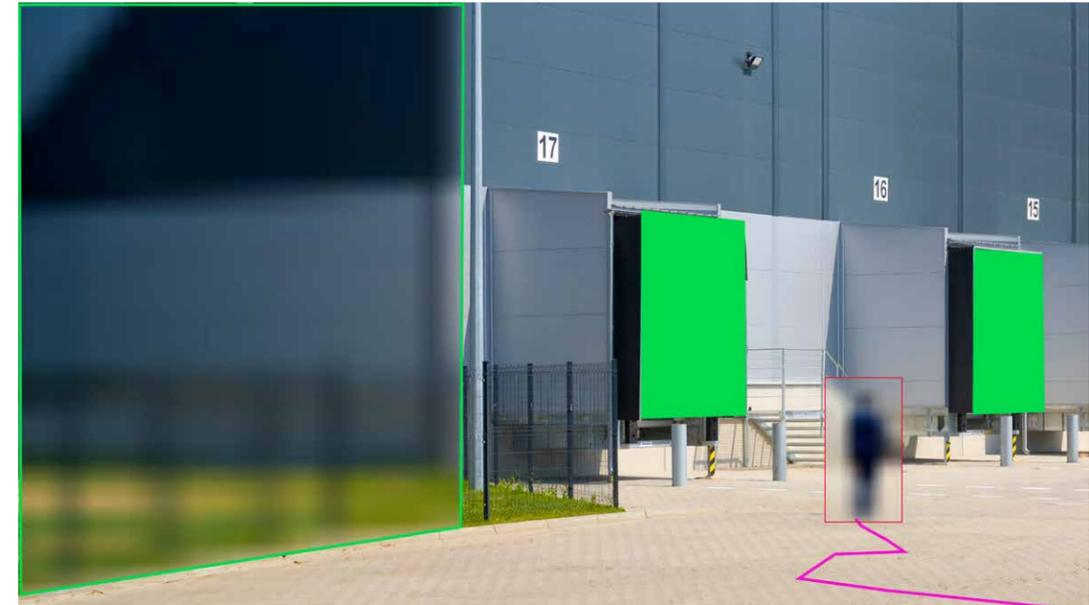
IPS Privacy Protection ist eine intelligente Videoanalyse für den Echtzeit-Schutz der Privatsphäre in überwachten Bereichen. Sie sorgt für die Maskierung oder Verschleierung von fixen Bereichen und mobilen Objekten, damit diese unkenntlich werden. Damit ermöglicht sie die zuverlässige Einhaltung von rechtlichen Rahmenbedingungen bei der Videoüberwachung von öffentlichen Bereichen. Sie ist einfach zu installieren sowie zu konfigurieren und für Innen- und Außenanwendungen geeignet.
